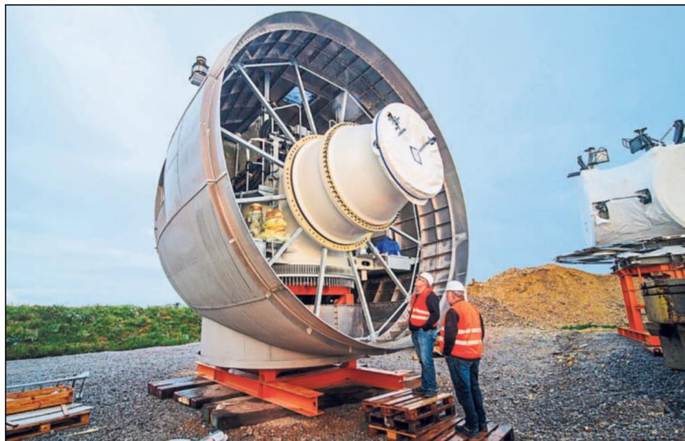
Besucher blicken in das Herzstück einer jeden Windkraftanlage, in das Maschinenhaus (im Bild eines für eine E101). Das Maschinenhaus hat einen Durchmesser von etwa sechs Metern.
