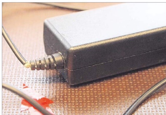
Kabelbruch tritt vor allem dort auf, wo es abrupte Übergänge beim Kabelanschluss von hartem auf weichen Kunststoff gibt. Foto: Schridde
